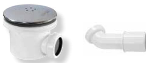
Sifon SIWM s průtokností min. 24 l/min., s vrchním čištěním, masivní víčko z pochromované mosazi
