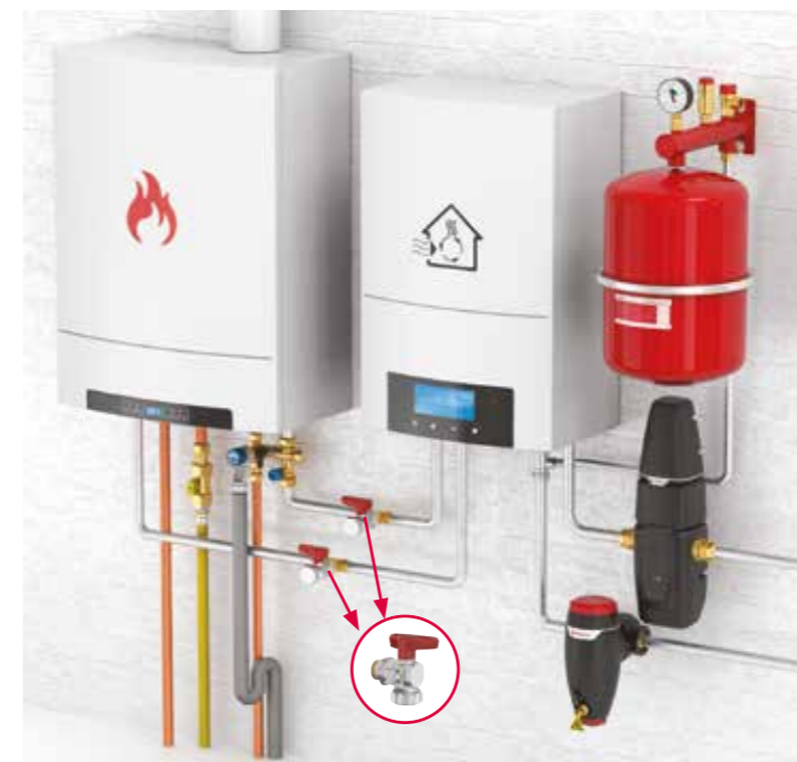
Příklad: s hybridním tepelným čerpadlem / plynovým kotlem
